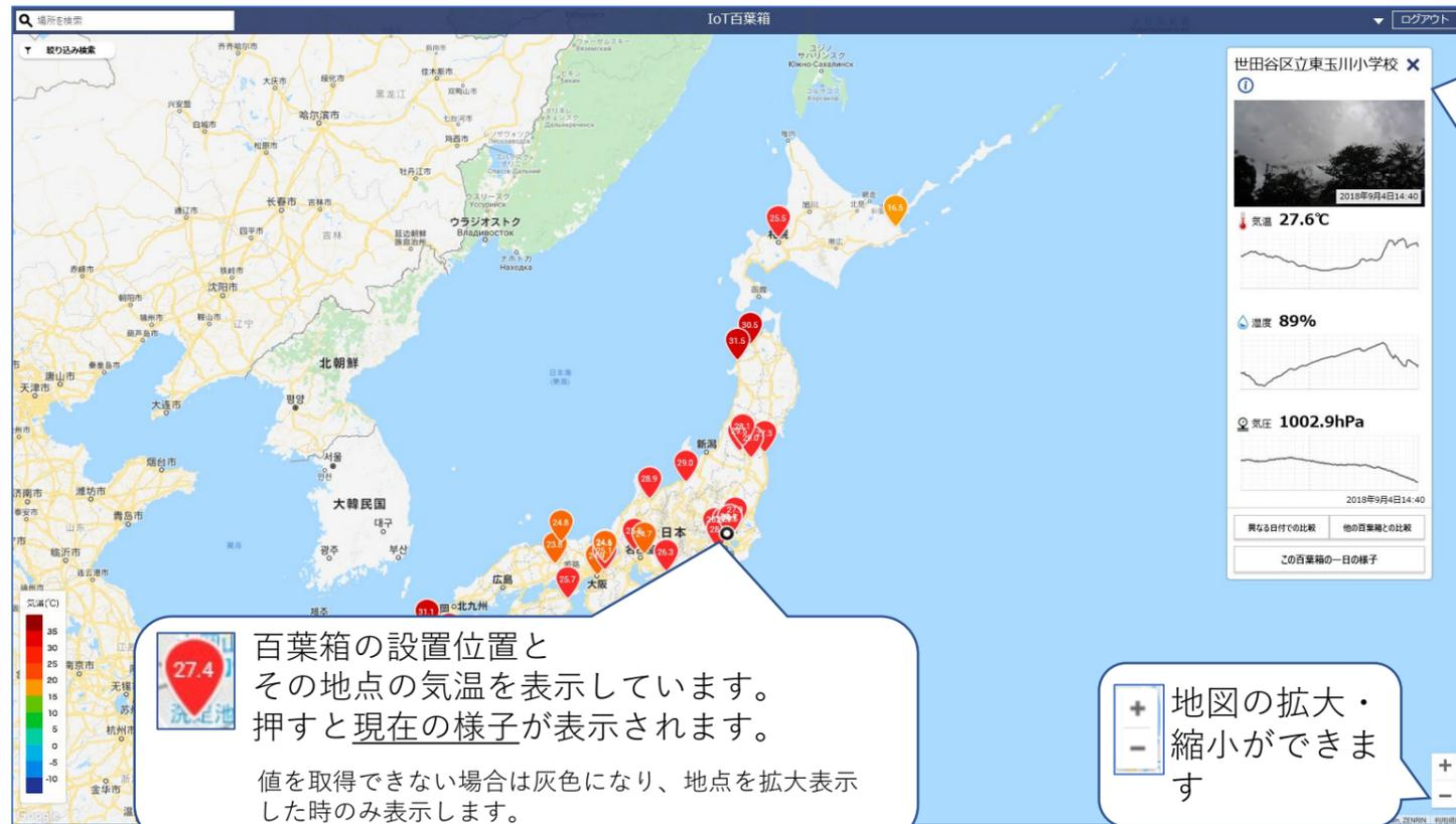
百葉箱の設置位置とその地点の気温を表示しています。押すと現在の様子が表示されます。値を取得できない場合は灰色になり、地点を拡大表示した時のみ表示します。
